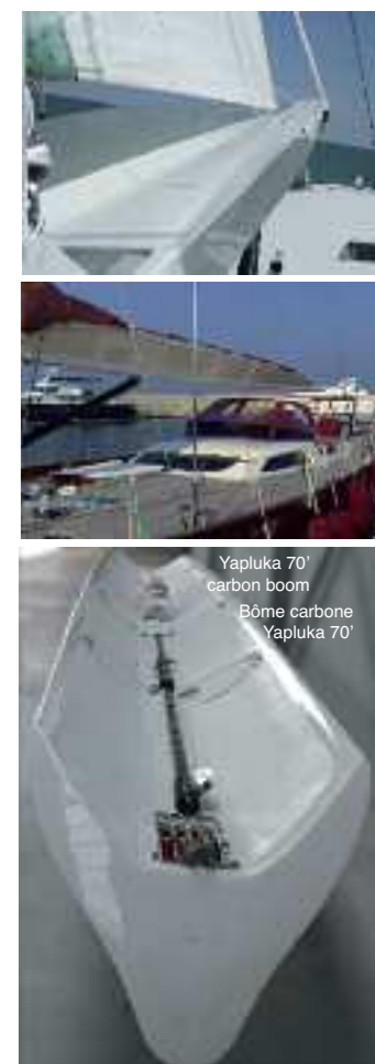
in-boom hydraulic or electric sheets Écoutes intégrées avec assistance hydraulique ou électrique
